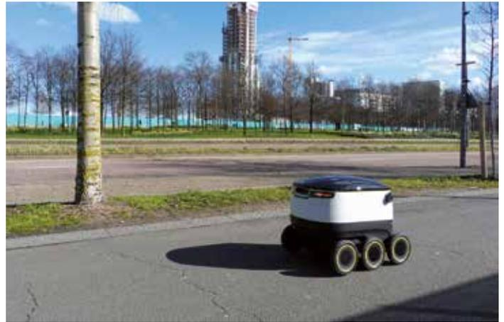
Zu Beginn werden die androiden Zusteller nur in Begleitung ausliefern. Kontrolliert werden sie aber von einer Zentrale, die über Kameras das Geschehen um den Roboter beobachtet. Nach Aussage des Betreibers werden hierbei keine Daten gespeichert. Entwickelt wurden die Postboten auf 6 Rädern von der Estländischen Firma Starship Technologies. Getestet wurden sie bisher in Tallinn, Washington und London. Bisher hat es, nach Aussage des Herstellers, noch keinen Unfall gegeben.
